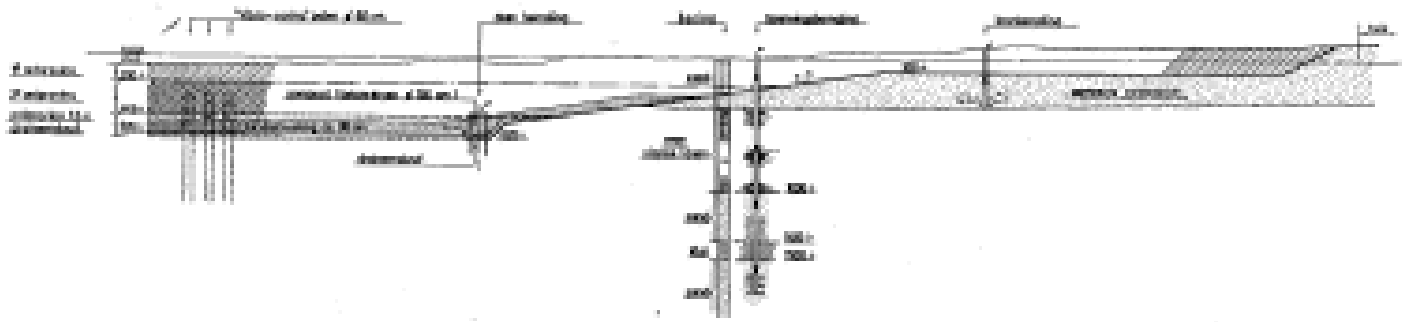
1 Overzicht bouwput institutengebouw met aangegeven de diverse hulpmaatregelen t.b.v. een blijvende stabiliteit van de bouwput
